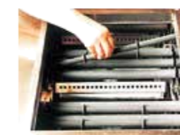
4.3.で乗せた倅生炭27φの中間に節付倅生炭を置いて完了。
